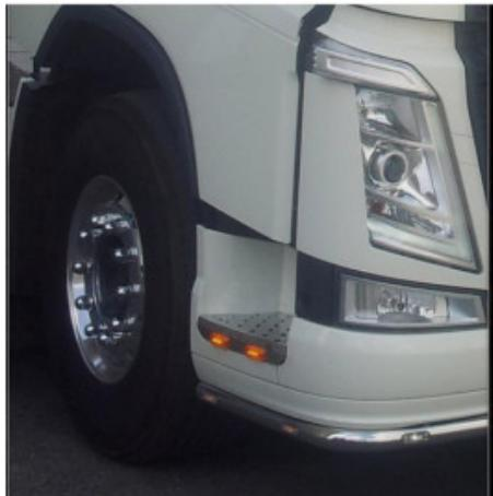
**Coperture gradini cabina in acciaio inox per Volvo fh 4^ (dal 2013)**
